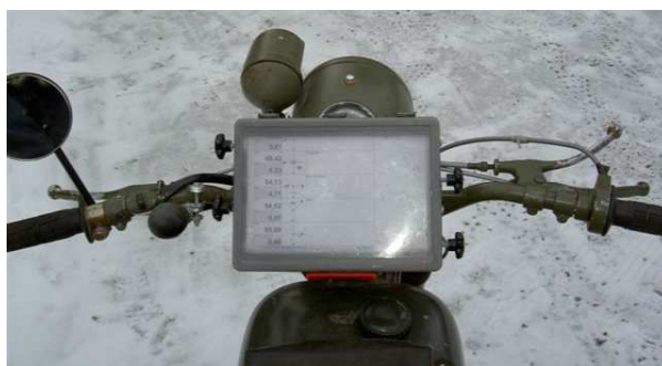
Vy över "cockpit" med roadbook, reglage och mörkläggningslampa. Notera de två bromshandtagen – med ett påverkar man bakbromsen när foten hålls på skidan.
